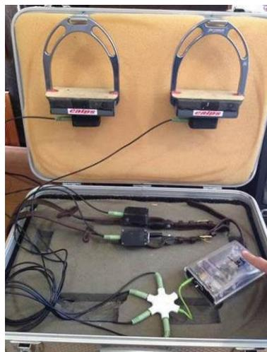
L'appui sur le bouton du boîtier de synchronisation déclenche des événements de synchronisation pour les capteurs qui lui sont connectés. L'horodatage de chaque appui est stocké dans la mémoire interne du boîtier de synchronisation. Il est ainsi possible pendant la séance de mesure de repérer à distance la fin de l'échauffement ou le début du cross.
