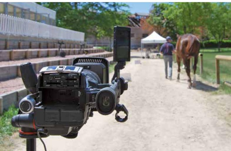
Relevé des paramètres morphologiques par morphométrie 3D lors du passage du cheval au pas entre 3 caméras
