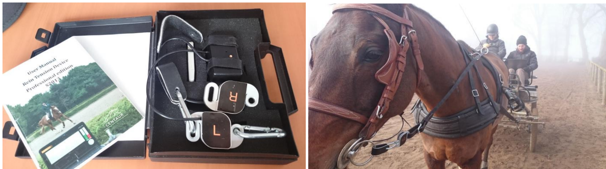
Figure I. A gauche, tensiomètre Centaur utilisé pour les mesures ; à droite : session de mesures de tension des guides (le meneur est accompagné par une personne chargée de la récupération des données sur ordinateur).
