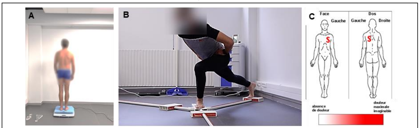
Figure 1 : Illustrations des évaluations effectuées : A – évaluation stabilométrique sur plateforme de force, B – évaluation fonctionnelle du « Y Balance test », C – évaluation des zones et intensités de la douleur.
