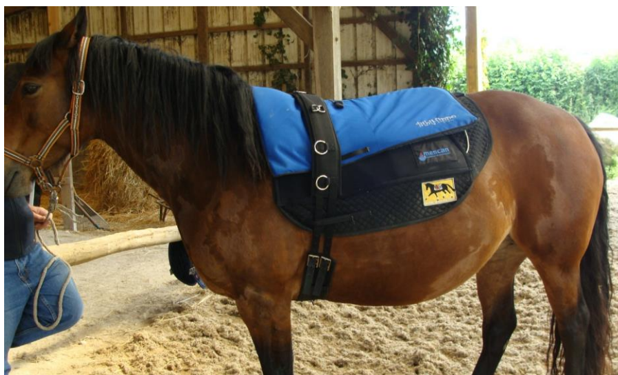
© Marianne Vidament – Tapis de monte à cru et nappe de mesure de pression
