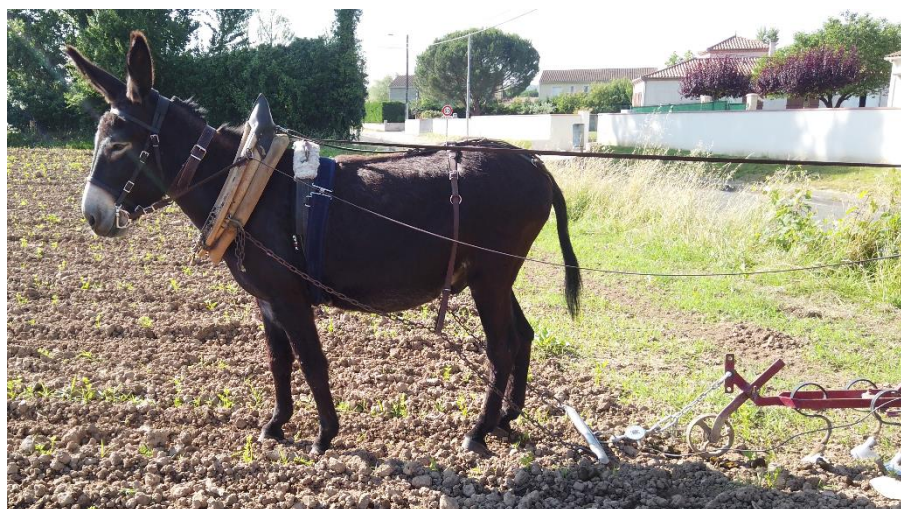
© Domitille Fouvez – Photo d'un âne maraîcher attelé lors des tests : il est équipé d'une ceinture Polar® pour la fréquence cardiaque et d'un dynamomètre situé au niveau de l'outil
