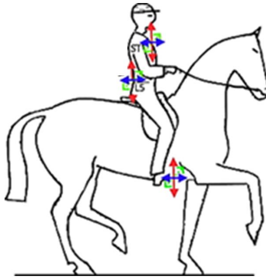
Figure 1. Positionnement des trois centrales inertielles (une sur le cheval et deux sur le cavalier).
