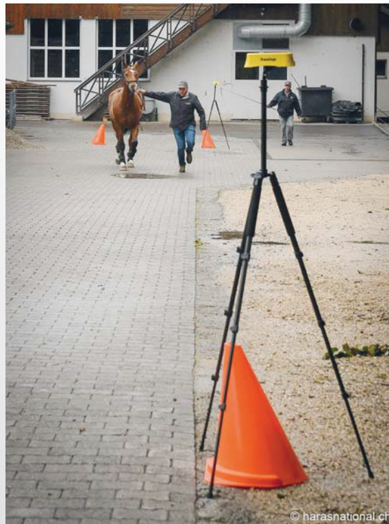
Figure 2: la vitesse du cheval était enregistrée à l'aide d'un chronomètre à barrage photoélectrique, Freelap (boîtier jaune).
